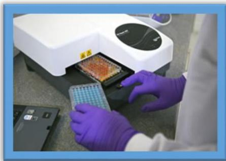
Figura 7 - Leitor de Microplacas Spectramax Hamilton 190.
