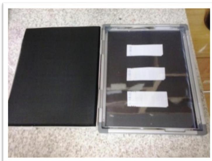
Figura 12 - Membranas de Nitrocelulose em Chassis de revelação.
