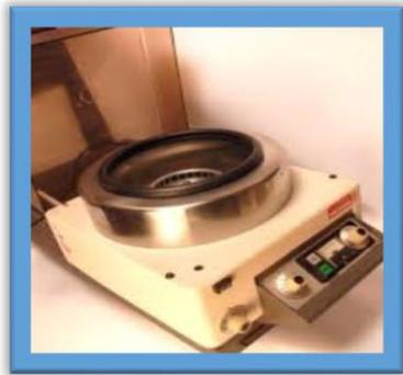
Figura 6 - Centrífuga modelo Mikro 220R Hettich, Alemanha.
